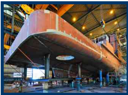
Neuheck. In der Werfthalle steht das 40 Meter lange und 13 Meter breite Segment bereit.
