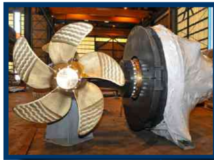
Rotation. Die um 360 Grad drehbaren Z-Antriebe arbeiten mit einem Zug- und einem Druckpropeller.
