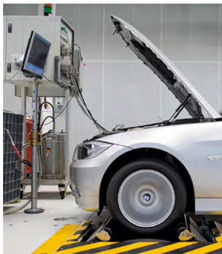
Nachhaltigere Kraftstoffe im Test auf dem Motorenprüfstand der BP/Aral-Forschung am Standort Bochum.
