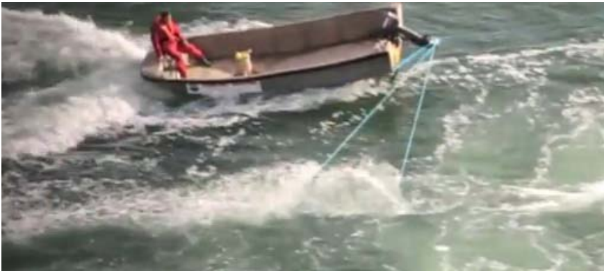
Abbildung 3: Durch Propylenseile blockierte Schiffsschraube eines Skiffs*
