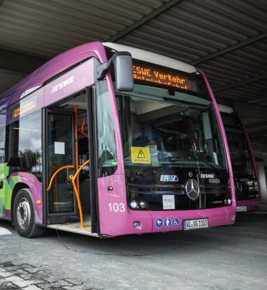
An den Ladestationen stehen maximal 150 kW Ladeleistung zur Verfügung. Damit dauert das „Betanken“ eines Busses je nach Batteriekapazität drei bis vier Stunden.
