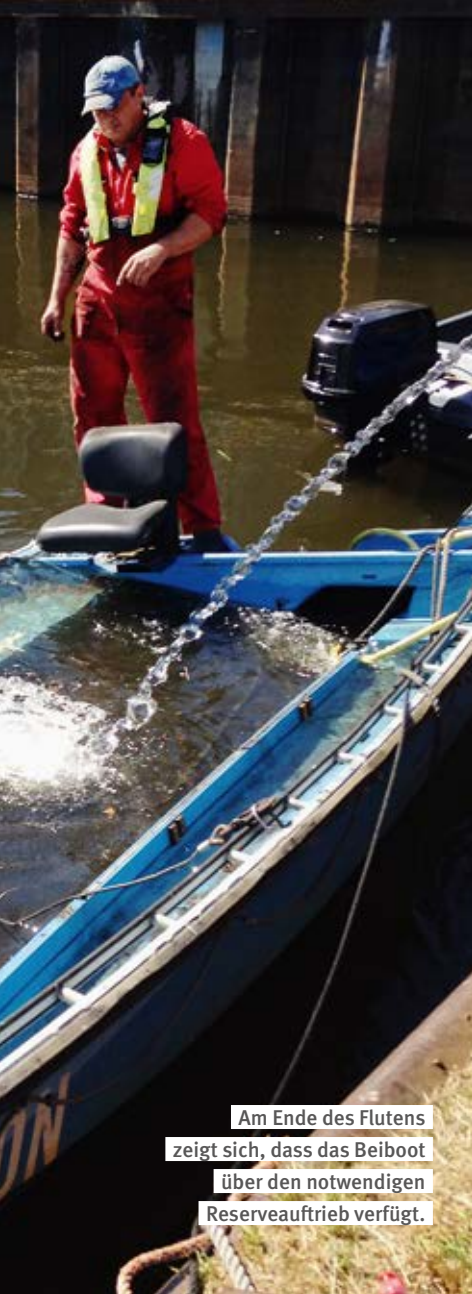
Beiboot bei der ES-TRIN-Prüfung während des Flutens.
