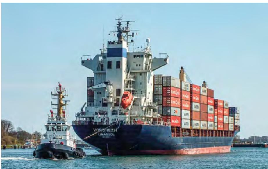
Die beiden Motoren verleihen dem Schlepper 32 Tonnen Pfahlzugkraft
