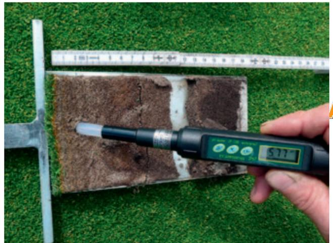
pH-Meter zur Bestimmung der Bodenreaktion im Bodenprofil. (Foto: K. Müller-Beck)
