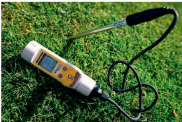
Leitfähigkeitsmessgerät zur Bestimmung der Salzkonzentration im Wurzelhorizont von Rasenflächen. (Foto: ISOM, 2020)
