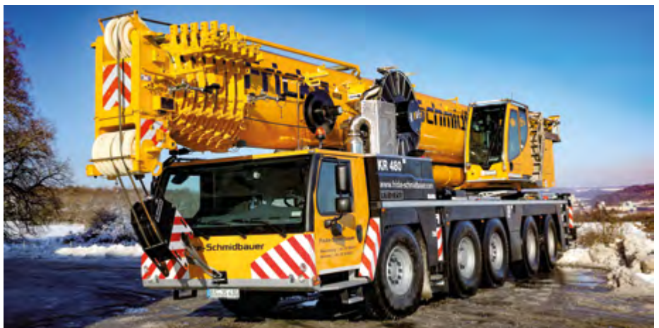
Der neueste 230-Tonnen-Mobilkran der Firma Liebherr
