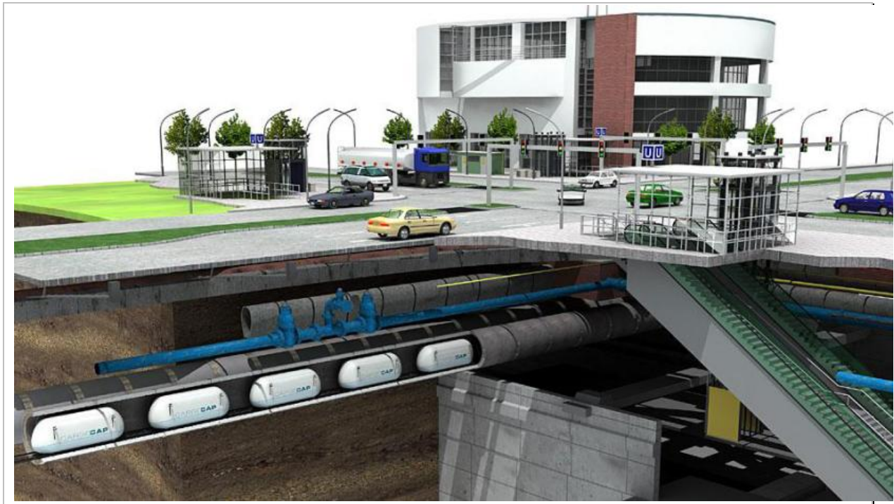
Abbildung 65 Unterirdischer Warentransport per Cargo-Cap
