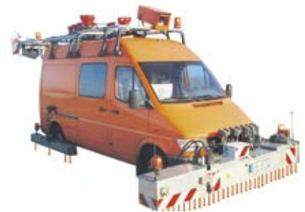
Messfahrzeug zur Zustandserfassung
