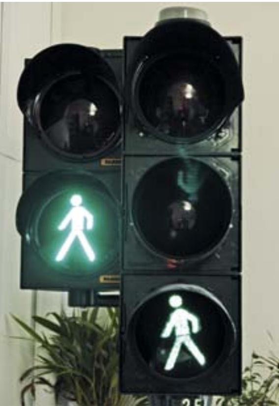
Signalleuchte mit Lichtemittierenden Dioden (LED) und Glühlampe (rechts)
