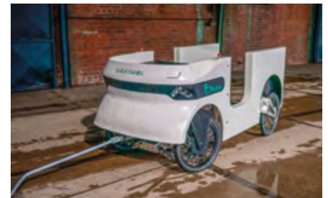
Das Fahrzeug wurde quasi um eine Euro-Palette herumgebaut
