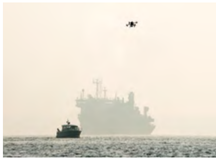
Drohne bei der Abgasmessung
