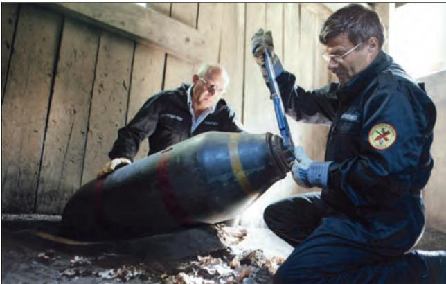
**Innovative Wege:** Peter Bodes (rechts) bei Vorversuchen zur Entwicklung von Fernentschärfungsgeräten. Erster Schritt der Entschärfung, das Entfernen des Schlagwerkes
