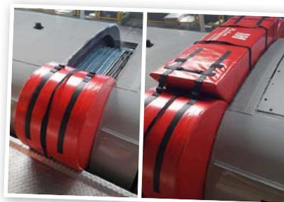
Spaltabdeckung an den Wagenübergängen mit durchsturzsicheren Formkörpern.
