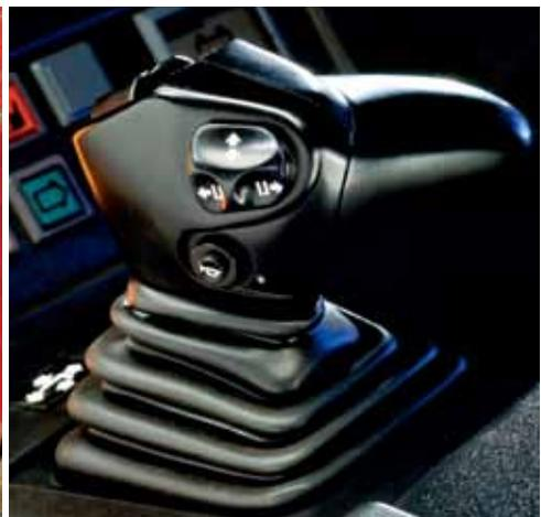
MULTI-PILOT: innovativer Steuerungshebel zur Ein-Hand-Bedienung.
