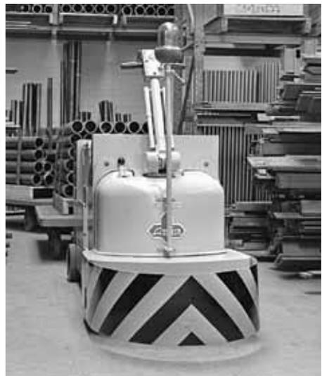
Erster Schritt in Richtung Automatisierung: das Fahrerlose Transportsystem „Teletrak“.
