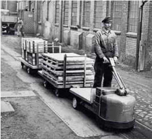
Bahnbrechender Antrieb: Die elektrisch angetriebene „Ameise“ ersetzt schnell den Handhubwagen.
