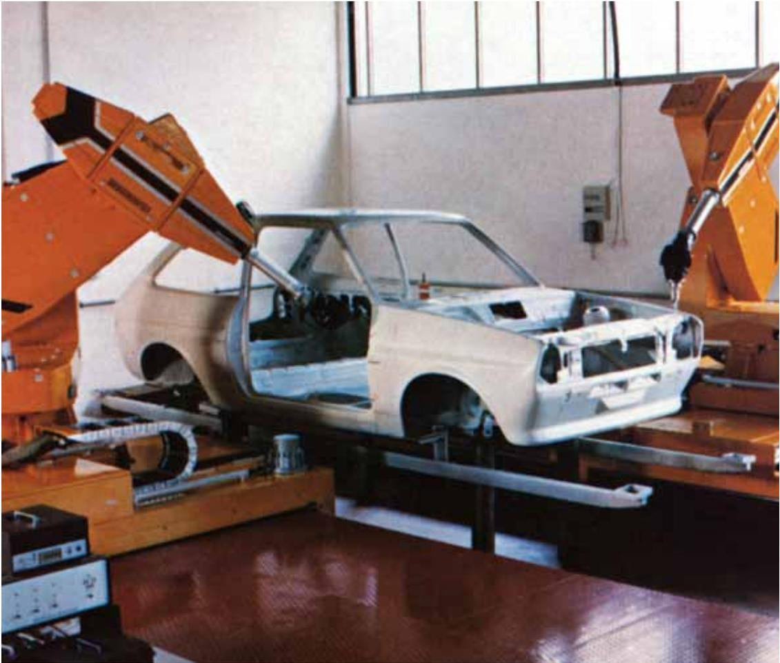
Automatisierung in der Fertigung: prozessgesteuerte Industrieroboter aus dem Hause Jungheinrich.
