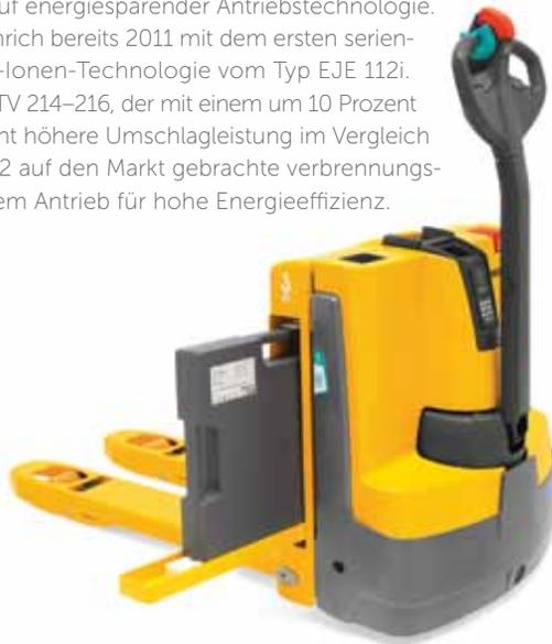
Neue Maßstäbe in der Energieeffizienz: Der EJE 112i ist das erste Serienfahrzeug mit Lithium-Ionen-Technologie.
