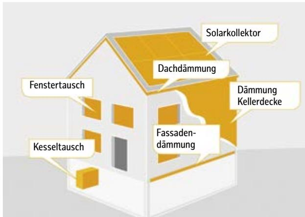
Ein energieeffizientes Haus besteht aus einer gedämmten Außenfassade mit neuen Fenstern, einem gedämmten Dach (oder obersten Geschossdecke), einem gedämmten Keller (oder einer gedämmten Kellerdecke) und einer modernen Heizungsanlage, ggf. mit erneuerbaren Energien.
