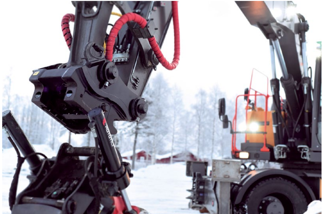
QuickChange™ ermöglicht Baggerfahrern, das hydraulische Anbaugerät zu wechseln, ohne die Kabine zu verlassen. (Foto: Rototilt)
