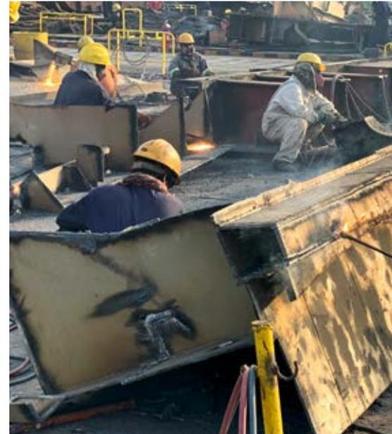
**Schweißen.** Ausgerüstet mit Helm, Schutzmaske und Handschuhen, zerteilen Arbeiter die Stahlteile.
