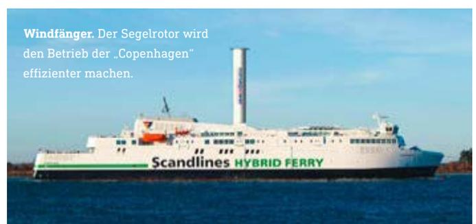
**Windfänger.** Der Segelrotor wird den Betrieb der „Copenhagen“ effizienter machen.
