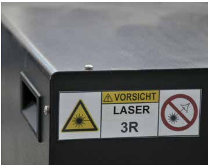
Abb. 38 und 39: Kennzeichnung von Lasern der Laserklassen 3R und 3B, Quelle: BG ETEM
