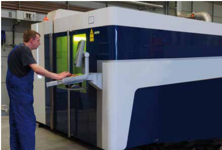
Abb. 43: Eingehauste Laserbearbeitungsmaschine, Quelle: Laserzentrum Nord
