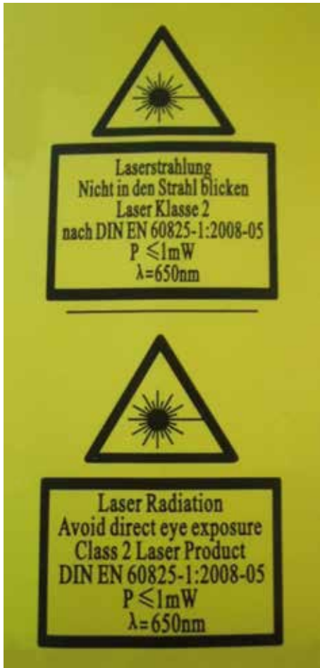
Abb. 14: Beispiel zur Kennzeichnung eines Lasers der Klasse 2, Quelle: BGV
