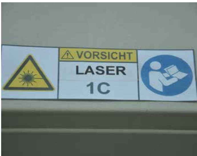
Abb. 40: Kennzeichnung der Laserklasse 1C, Quelle: BG ETEM
