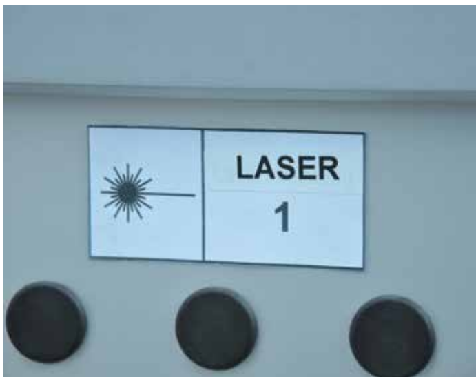
Abb. 33 und 34: Kennzeichnung von Lasern der Laserklassen 1 und 1M, Quelle: BG ETEM
