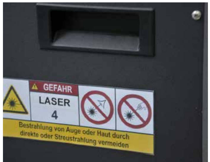
Abb. 41: Kennzeichnung der Laserklasse 4, Quelle: BG ETEM
