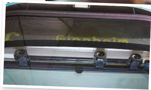
Die Kameras sind außerhalb des Sichtbereiches der Fahrer angebracht und müssen sich im überwachten Bereich der Scheibenwischer befinden
