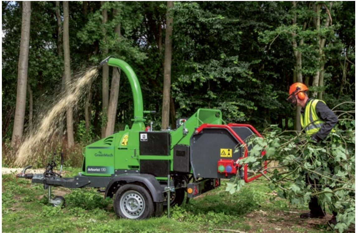
Die Disc-Messer sind mit 10 cm Durchmesser selbst für Stämme bis 22 cm geeignet. (Foto: GreenMech Deutschland GmbH)
