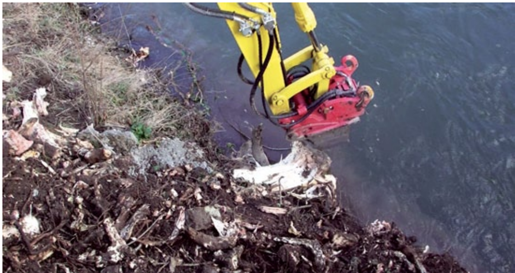
Roden ohne Einschränkungen: Die Wurzelratte darf auch – wie hier dargestellt – am oder im Wasser verwendet werden. (Foto: Wurotec GmbH & Co. KG)
