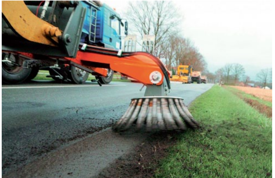
Vielfältiger Einsatz - Bankettenreinigung und Wildkrautbeseitigung mit dem bema Groby. (Foto: bema GmbH Maschinenfabrik)
