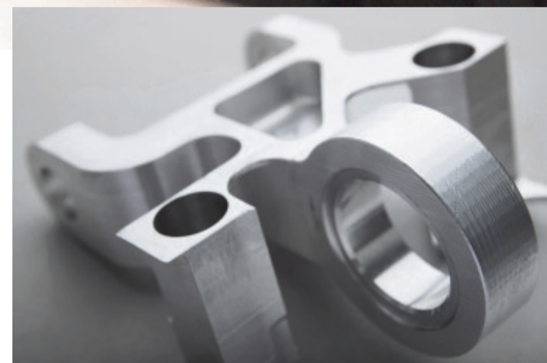
Moderne NC-Maschinen vereinigen Fräsen und Bohren in einem Arbeitsgang. Auch hier ist der Programmieraufwand hoch, der letztlich die mechanischen Bewegungen der Spindel steuert und die Werkzeuge vorgibt – in diesem Fall ein Bohrer.
