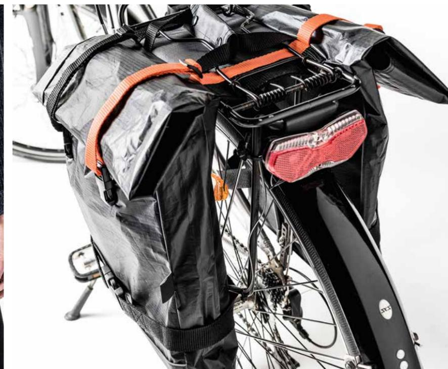
Der Clou: Mit der Leichtigkeit geht eine ungeahnte Strapazierfähigkeit einher. Heike de Quadros gibt offiziell eine Belastbarkeit von bis zu 45 Kilogramm an. Tatsächlich hat sich unter Laborbedingungen im ITP-Test gezeigt, dass sie bis zu 135 Kilogramm aushält, bevor die ersten Nähte reißen. „Das konnten wir selbst kaum fassen“, sagt die Designerin.
