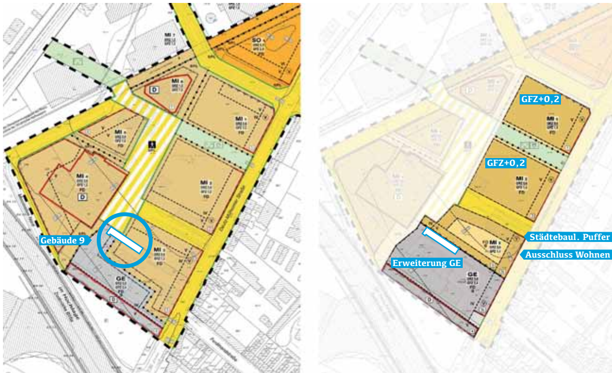
Vereinfachte Darstellung der Entwurfsänderungen für den Bebauungsplan »Euroforum Nord in Köln-Mülheim« Quelle: Stadt Köln
