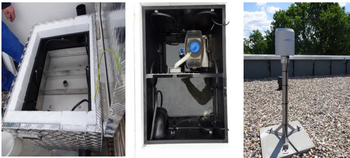
Abb. 12: Messbox mit Kippzählertechnik (links) und dualem Messsystem (mitte) und Regenmesser nach HELLMANN (rechts)
