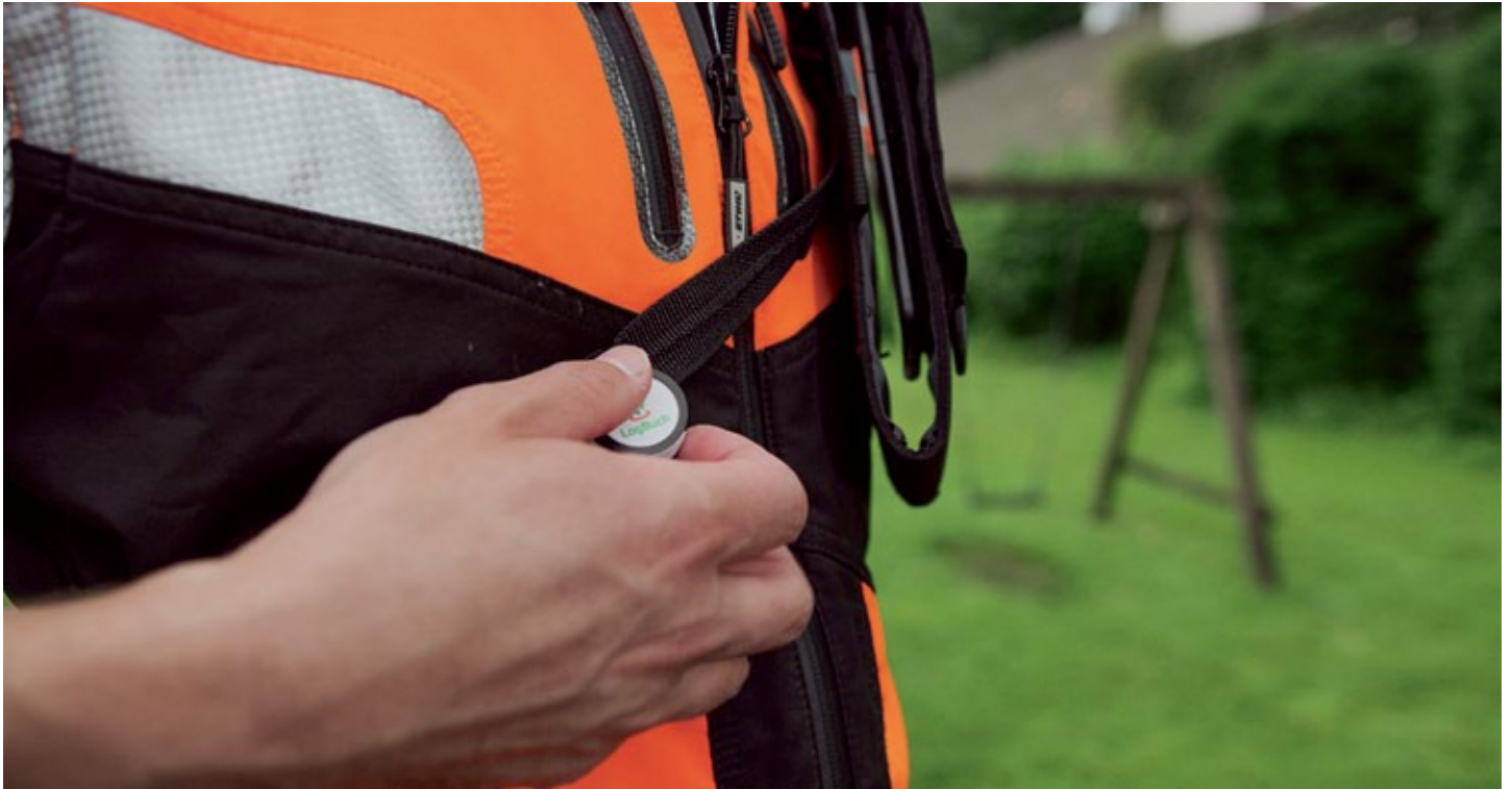
Per Knopfdruck via Bluetooth lassen sich Sprachaufnahmen starten. So ist die Lösung von STIHL bei jedem Wetter mit freien Händen bedienbar. (Fotos: STIHL)
