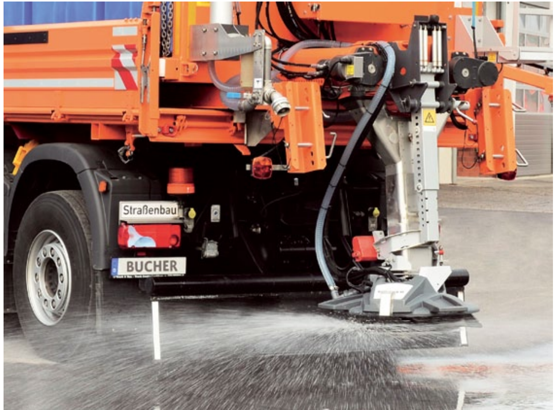
Die Sprüheinheit BrineStar® ermöglicht es, reine Sole gleichmäßig bis zu einer Breite von 12 Metern zu verteilen. (Foto: Bucher Municipal Wernberg GmbH)
