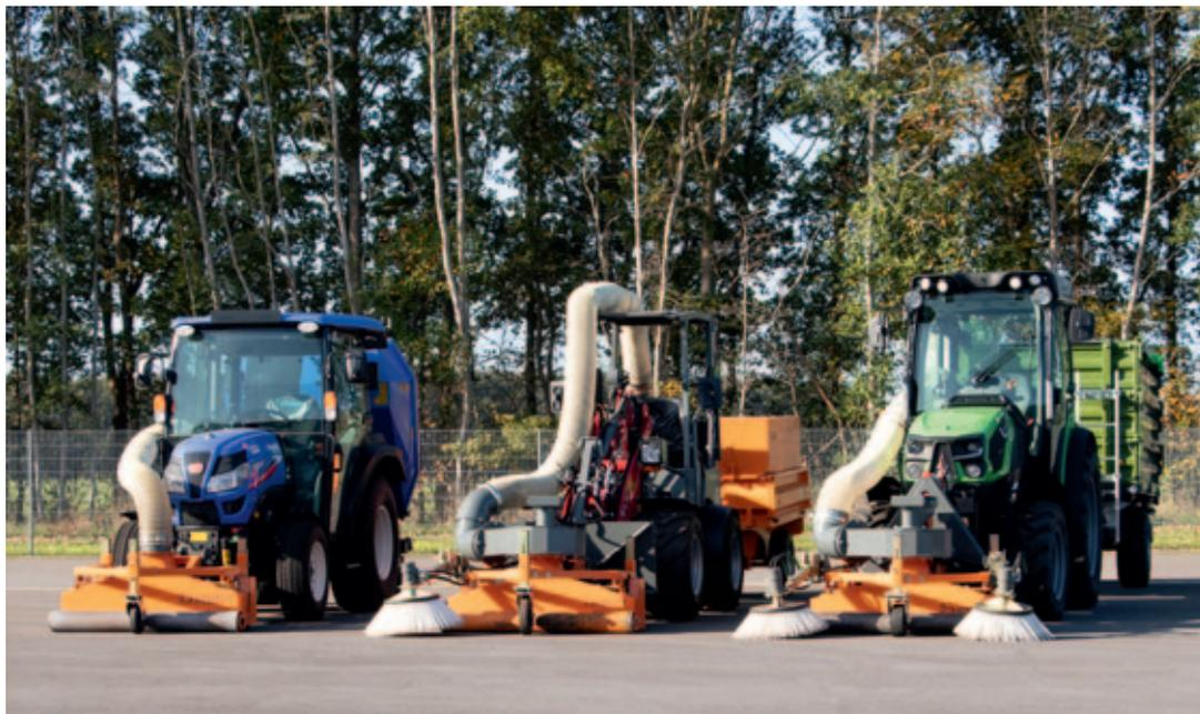
Die bema Saug-Kehrdüse im Frontanbau in verschiedenen Varianten: links ohne Häckselgebläse kombiniert mit vorhandenem Saugcontainer im Heck, Mitte/Rechts mit Häckselgebläse und Seitenkehrbesen kombiniert mit vorhandenem Sammelanhänger im Heck. (Foto: bema GmbH Maschinenfabrik)
