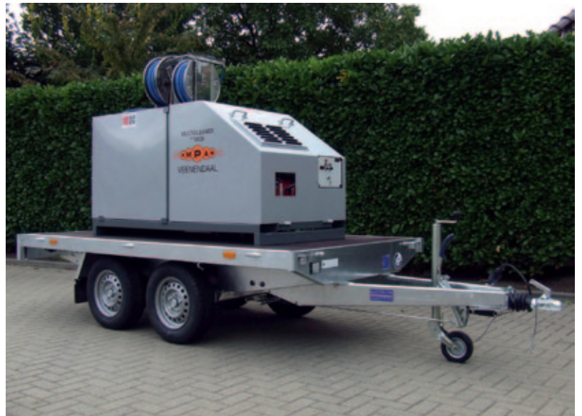
Empas MCB – Basisgerät für die Heißwasser-Wildkrautbekämpfung und -reinigung, Foto: Empas
