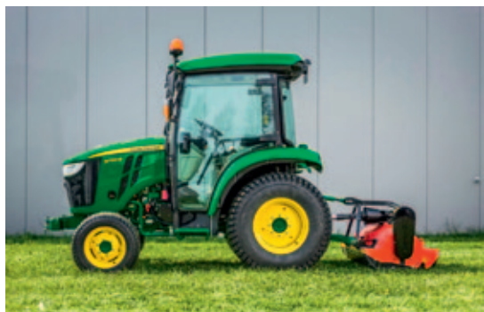
Alle weiteren Modelle der 2R- und 3R-Serie über 25 PS erhalten einen neuen 1,6Liter-Dreizylinder-Dieselmotor der TNV-Serie von Yanmar.
