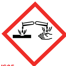
GHS05 Ätzwirkung für Stoffe und Gemische, die auf Metalle korrosiv, hautätzend und / oder schwer augenschädigend wirken
