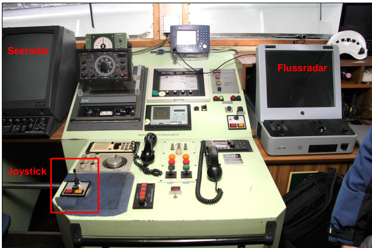
Abbildung 25: Fahrstand der EVERT PRAHM, Joystick-Steuerung, aufgenommen am 08.01.2016
