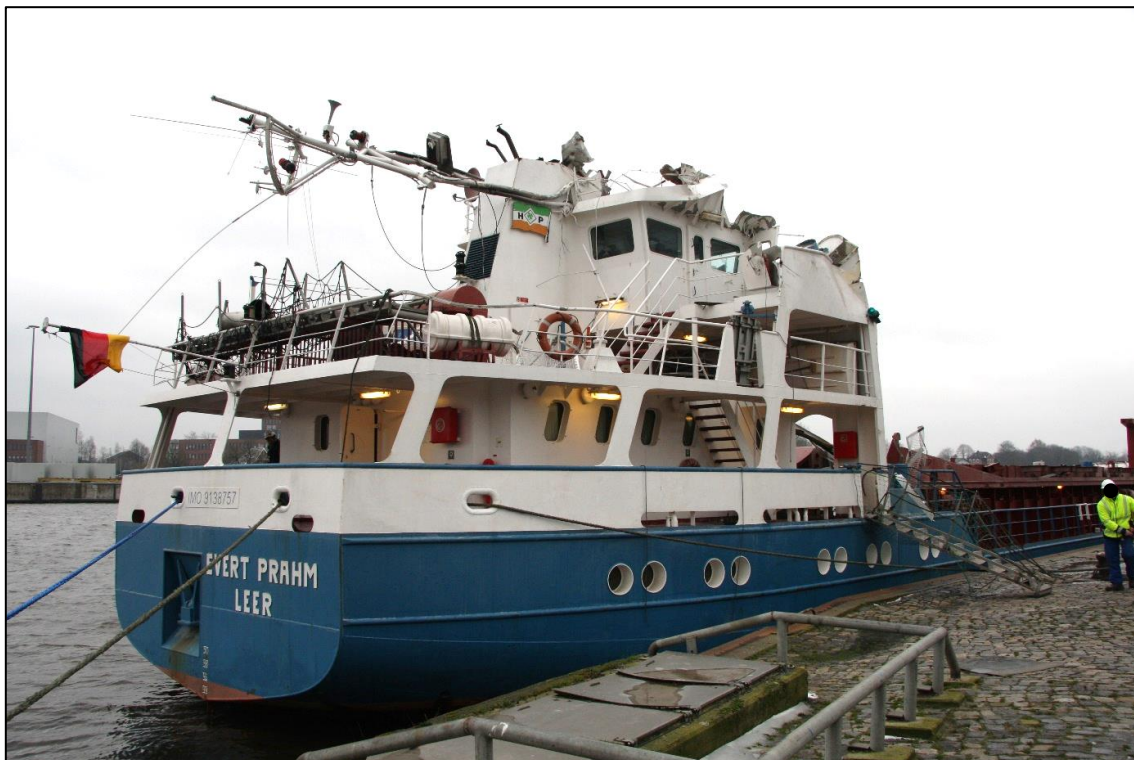
Abbildung 29: Schäden an den Aufbauten der EVERT PRAHM, Sicht von achtern
