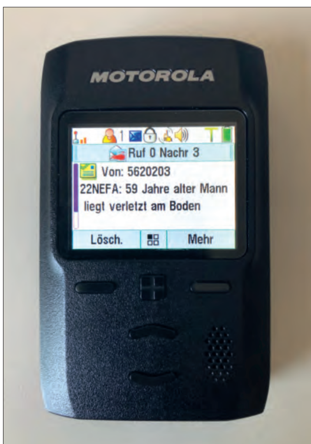
Digitales Alarmierungssystem: Der Tetra-Meldeempfänger von Motorola
