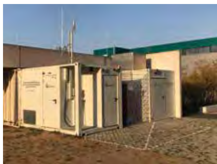
Nicht viel größer als ein Buswartehäuschen: Plasmalyzer-Testanlage zur Gewinnung von Wasserstoff aus Schmutzwasser in Berlin.
