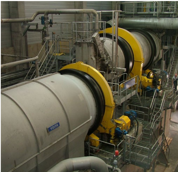
Auflösetrommel (Alternative zum Pulper)
