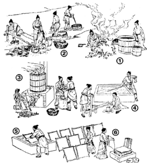
Abb. K 3.10-2 Chinesische Papierherstellung aus Maulbeerbaumbast mit einem Sieb mit starrem Rand 1: Bastfasergewinnung (Maulbeerbaum), 2: Waschen der Fasern, 3: Kochen und Stampfen, 4: in Wasserbütte aufschwimmen, 5: mit Sieb Faservlies schöpfen, 6: Siebe zum Trocknen aufstellen, getrocknetes Papier abnehmen
