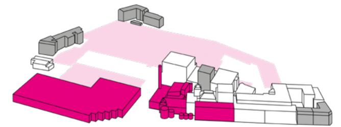
Erst ab Januar 2021 wird die große Halle der ehemaligen Flaschenabfüllanlage abgerissen – sie dient bis dahin der Lagerung von Abbruchmaterial und Schutt. Auch das alte Kessel- und Maschinenhaus weicht für die Neubebauung.
