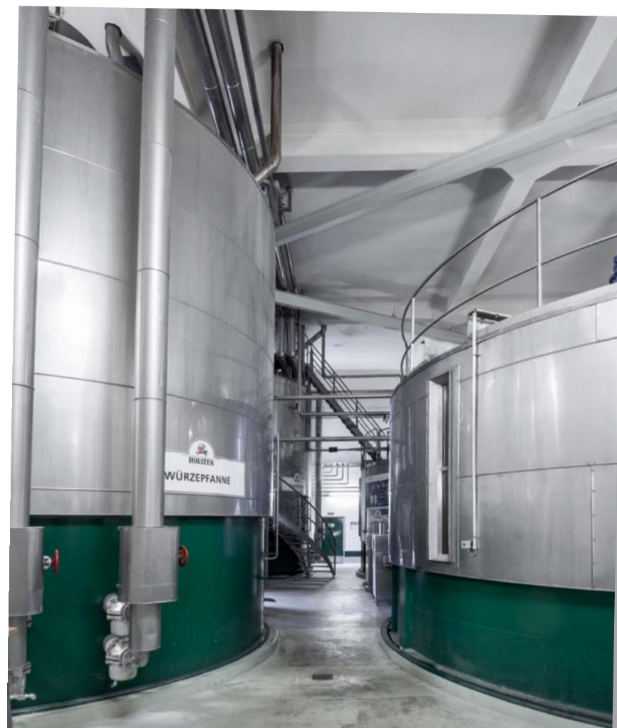
Im Inneren der Hallen stehen unter anderem die großen Braukessel.
