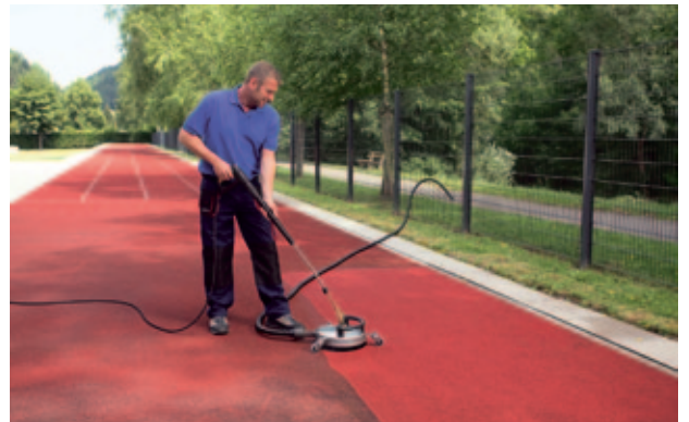
Auch Tartanbahnen müssen regelmäßig von Schmutz befreit werden, damit sie in gutem Zustand bleiben. Zum Einsatz kommen dabei häufig Flächenreiniger mit 30 bis 50 cm Arbeitsbreite.
