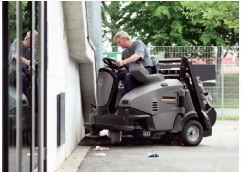
Mit einer Kehrmaschine kann der lose Schmutz dann aufgenommen werden.
