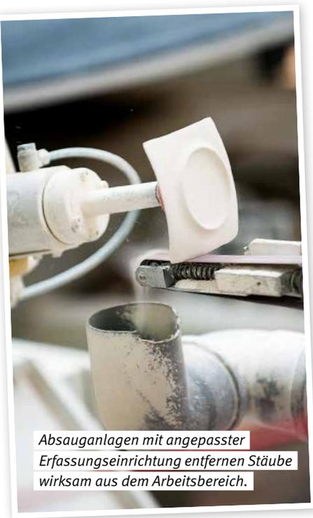
Absauganlagen mit angepasster Erfassungseinrichtung entfernen Stäube wirksam aus dem Arbeitsbereich.
