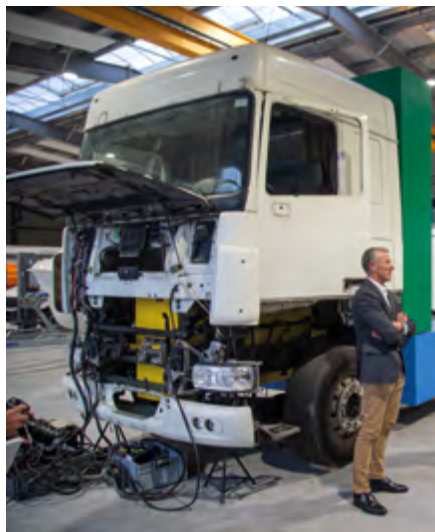
Wasserstofftank hinter der Kabine
