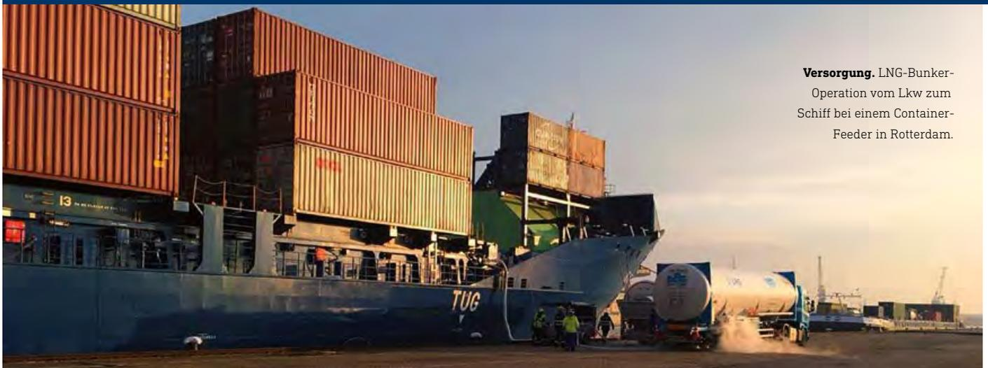
**Versorgung.** LNG-Bunker-Operation vom Lkw zum Schiff bei einem Container-Feeder in Rotterdam.
