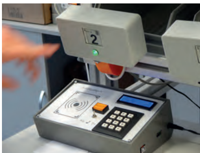
Mit diesem Gerät wird die Auftragsfolge festgelegt, woraufhin die entsprechenden LED Lämpchen aufleuchten.
