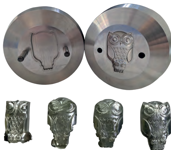
Das Gesenk (oben) und das Ergebnis der ersten Prägeversuche (unten). Nach und Nach ist eine starke Verbesserung der Prägung zu erkennen
