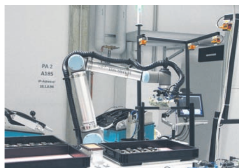
Eigenentwicklung: Dieser Roboter prüft elektronische Bauteile bei Garz und Fricke.
