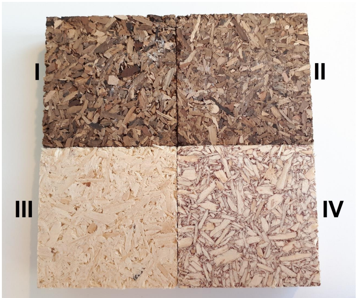
Abbildung 4-13: Vergleich der vier Spanplattentypen
