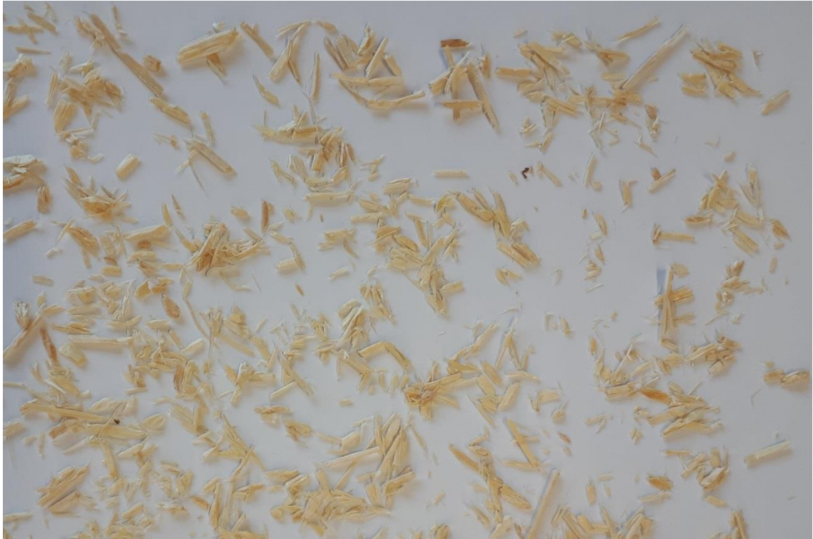
Abbildung 4-11: Späne aus Fichte, Nahaufnahme der Form
