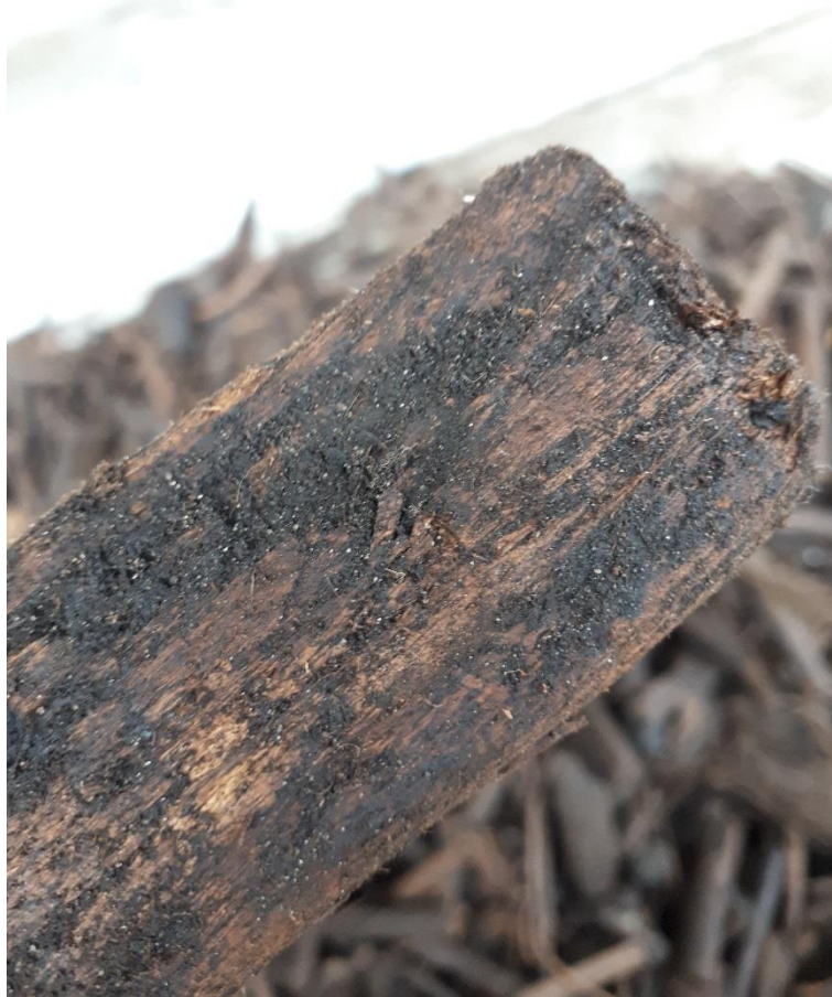
Abbildung 3-5: Holzstück aus Siebüberlauf mit Anhaftungen aus der Kompostierung
