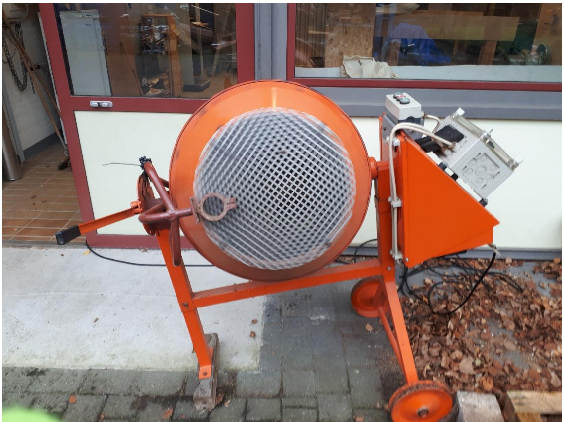
Abbildung 3-16: Versuchsaufbau 3: Mischtrommel ohne Schaufeln, mit Lochgitter
