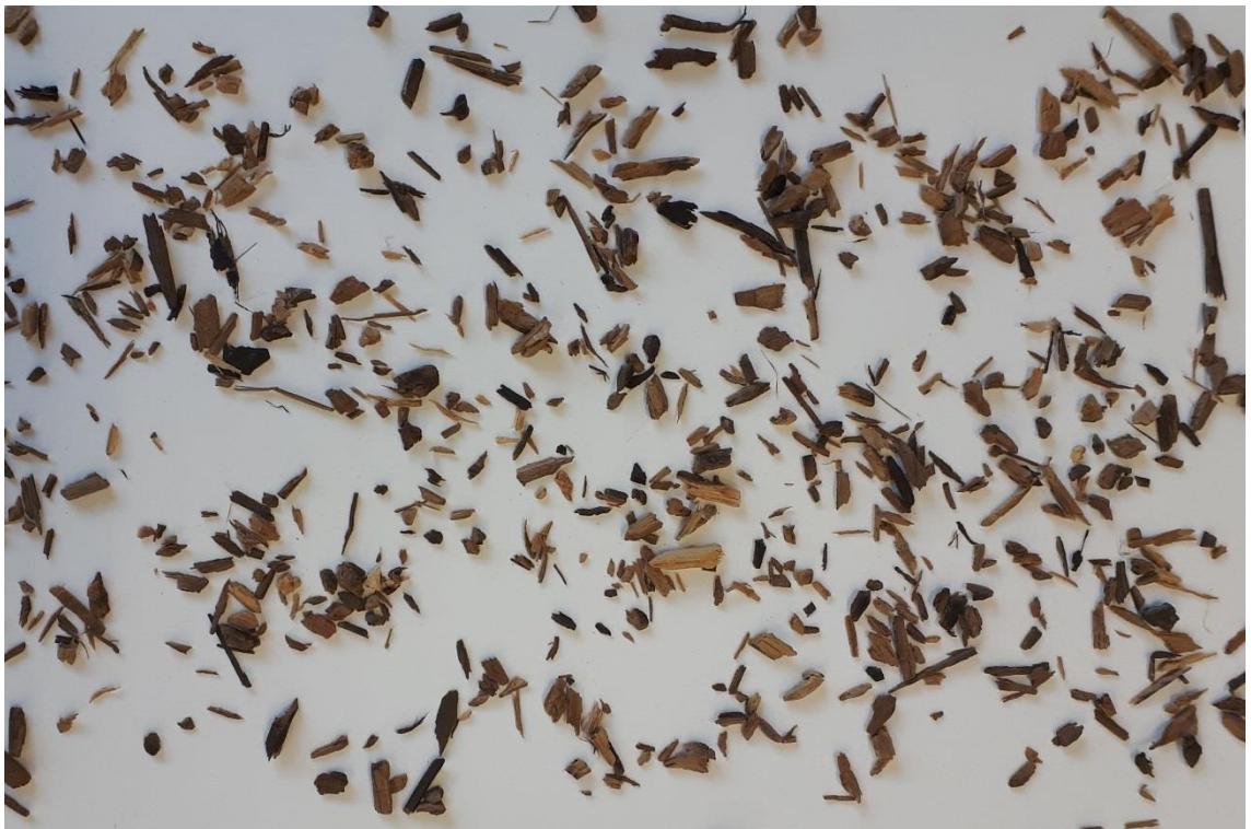
Abbildung 4-10: Späne aus Siebüberlauf, Nahaufnahme der Form
