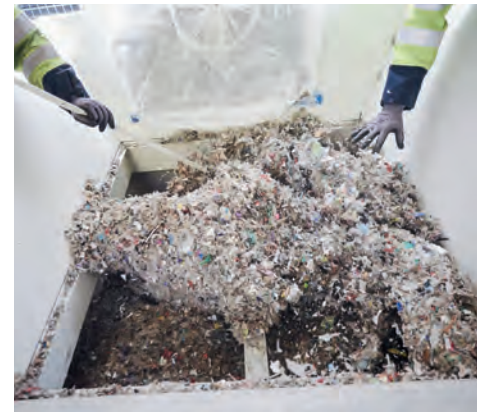
Kunststoffabfälle, die zu synthetischem Öl verarbeitet werden, liegen in einem Behälter in der ReOil®-Anlage.
