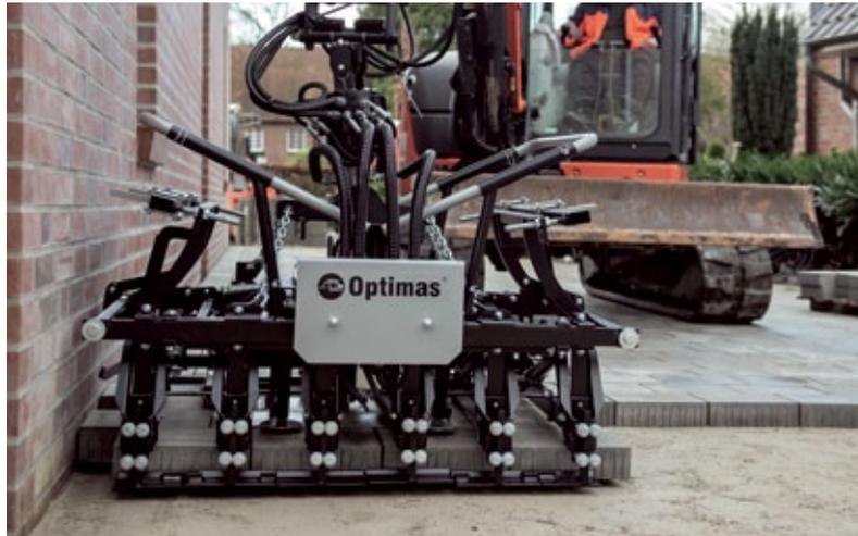
Der Optimas Pflastergreifer Multi6 M kann direkt an die Wand verlegen. (Foto: Optimas GmbH)
