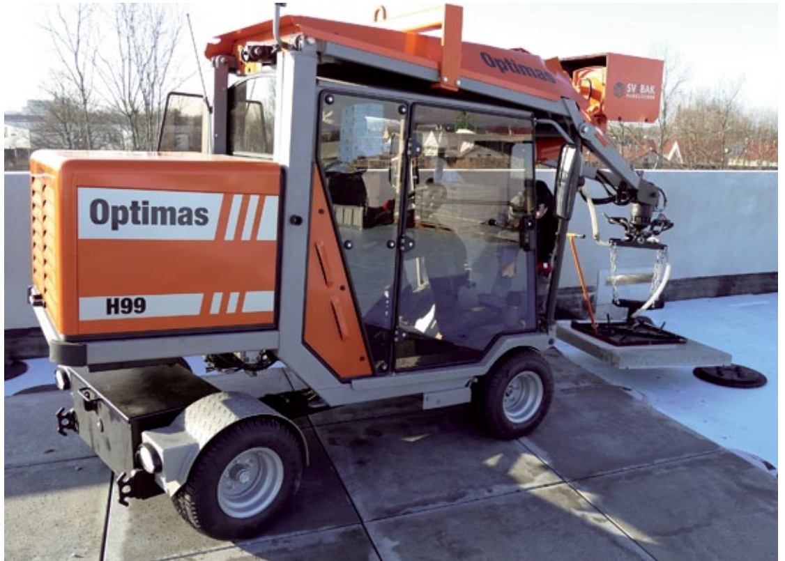
Das Optimas Vakuumgerät BE hält die schwere Platte, auch über längere Transportwege, problemlos fest. Die Verlegung mit der Optimas H99 wird dadurch sehr einfach. (Foto: Optimas GmbH)
