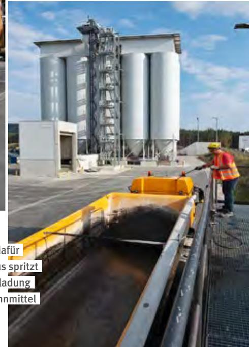
Von einer speziell dafür gebauten Bühne aus spritzt Schmid vor der Beladung mit Asphalt ein Trennmittel in die Mulde.
