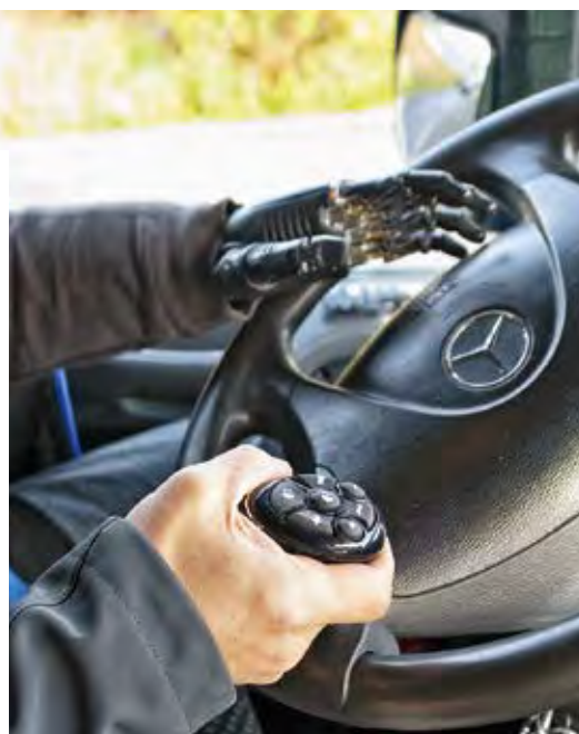
Der Lkw erhielt am Lenkrad einen Handgriff mit Multifunktionsknopf, über den unter anderem Blinker, Hupe und Licht bedient werden.
