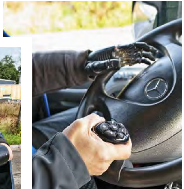
Der Lkw erhielt am Lenkrad einen Handgriff mit Multifunktionsknopf, über den unter anderem Blinker, Hupe und Licht bedient werden.
