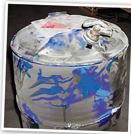
Fass nach Explosion! Unüberlegtes Handeln führt zu schwerwiegenden Folgen.
